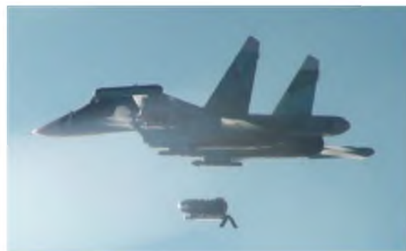
Рис. 4. – Падение фугасной авиационной бомбы ФАБ-500 с УМПК.
